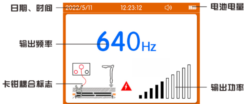
图 5-14 管线探测模式卡钳耦合输出界面
