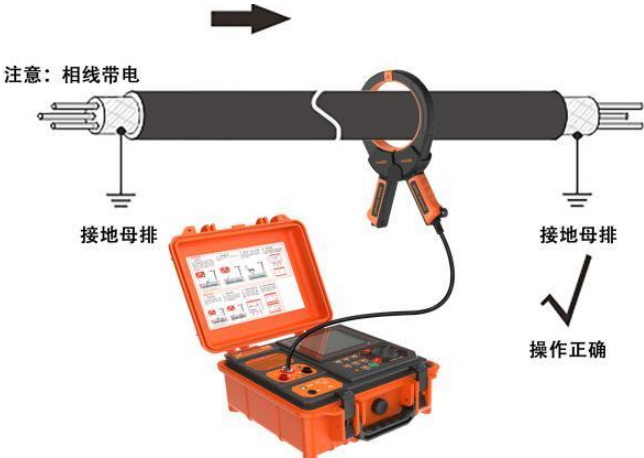
图 5- 16 运行电缆卡钳耦合 1（卡电缆本体）
