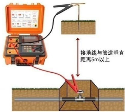
图 5-4 金属管道直连法接线图
